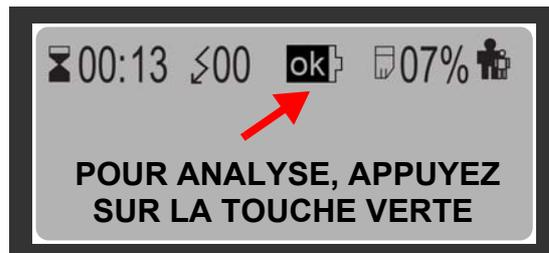
Fig. 3.2 Capacité suffisante de la pile
