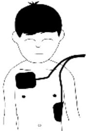
**Fig. 3.10** Points d'application des électrodes pédiatriques
