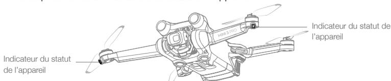
Lorsque l'appareil est sous tension mais que les moteurs ne tournent pas, les indicateurs du statut de l'appareil affichent le statut du système de contrôleur de vol. Reportez-vous au tableau ci-dessous pour en savoir plus sur les indicateurs du statut de l'appareil.
