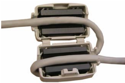
Fig. 5.10 Mise en place du câble dans le noyau ferrite
