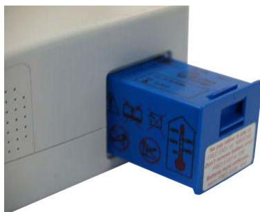
Fig. 3.1 Mise en place de la pile
