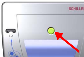
Fig. 4.1 Touche de mise en marche/arrêt et de déclenchement de l'analyse
