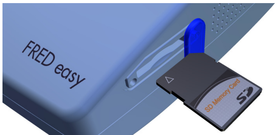
Fig. 5.1 Mise en place de la SD Card (écriture vers le haut, respectez le sens de la flèche)
